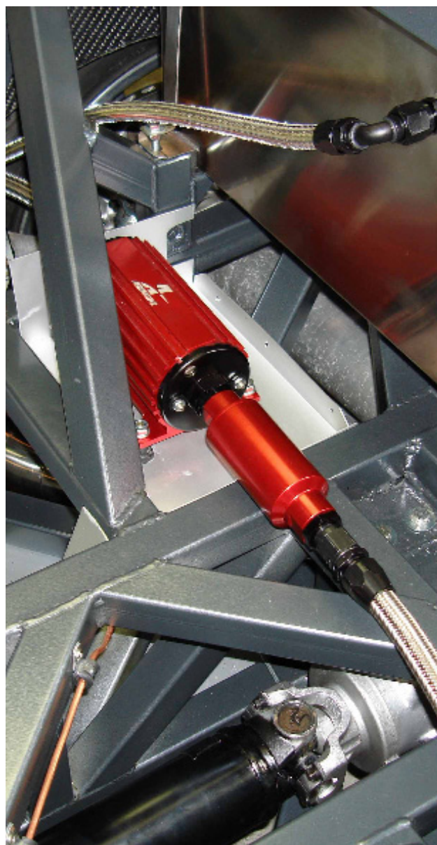
Här töms returen direkt i huvudtanken, för att hålla nere bränsletemperaturen. Placera bränslekomponenterna på en skyddad position.
