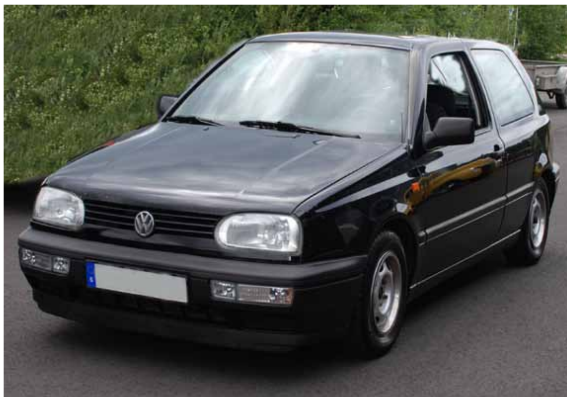
DEN HÄR GOLFEN KRÄVDE BÅDE KRAFTIGARE FJÄDRAR/STÖTDÄMPARE OCH DÄCK FÖR ATT KLARA AV DEN ÖKADE VIKTEN VID ELKONVERTERINGEN
