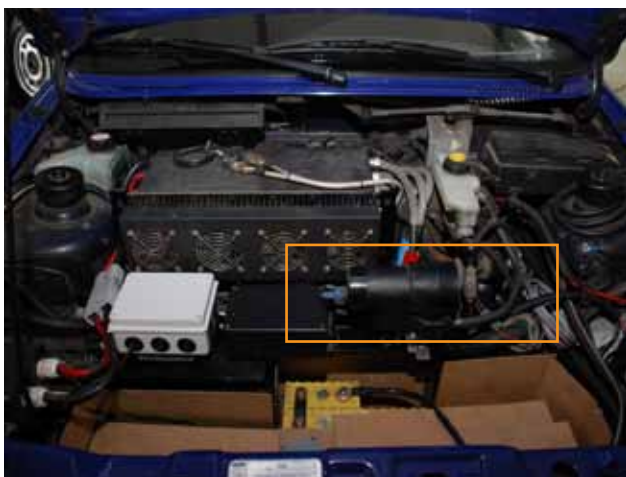
ELKONVERTERAD FORD FIESTA MED ELEKTRISK VAKUUMPUMP FÖR BROMSSERVOT (INRINGAD)
